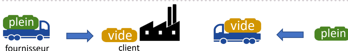
Principe de réapprovisionnement en stockage gazeux
